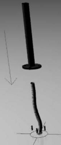
Posizionare a pavimento il supporto in ferro facendo passare il tubo flessibile in polipropilene al suo interno.
