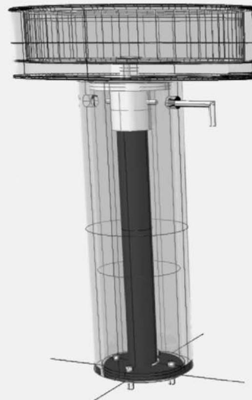
Posizionare, centrandolo, il lavabo sulla colonna, avendo cura che il tubo del supporto in ferro sia inserito nel cilindro della piastra di fissaggio; stringere infine i grani montati sul cilindro, utilizzando i fori previsti sulla colonna in ceramica, per fissare definitivamente il lavabo alla colonna.
