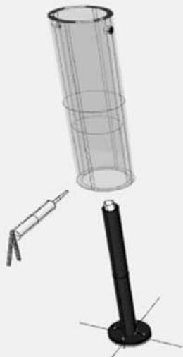
Posizionare la colonna in ceramica a pavimento, dopo aver applicato del silicone per tutto il perimetro della base, facendo passare il supporto in ferro al suo interno.
