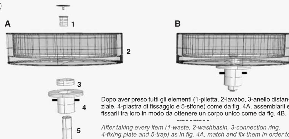
Dopo aver preso tutti gli elementi (1-piletta, 2-lavabo, 3-anello distanziale, 4-piastra di fissaggio e 5-sifone) come da fig. 4A, assemblarli e fissarli tra loro in modo da ottenere un corpo unico come da fig. 4B.
