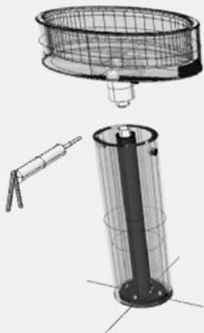
Collegare il tubo flessibile, tramite la relativa ghiera, al sifone di scarico e successivamente applicare del silicone per tutto il perimetro sulla superficie della colonna in ceramica.
